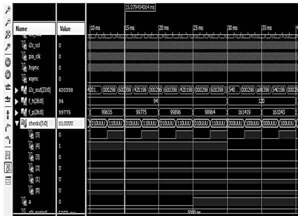
Hình 6. Mô phỏng hoạt động của bộ tìm chế độ màn hình và đo tần số đồng bộ VGA
